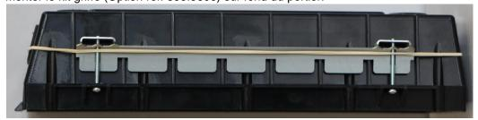
Fixer le fond du portier dans la réservation à l'aide des griffes puis raccorder le portier. Fixer la face avant avec les 6 vis FX (TORX) à téton M3-10.
