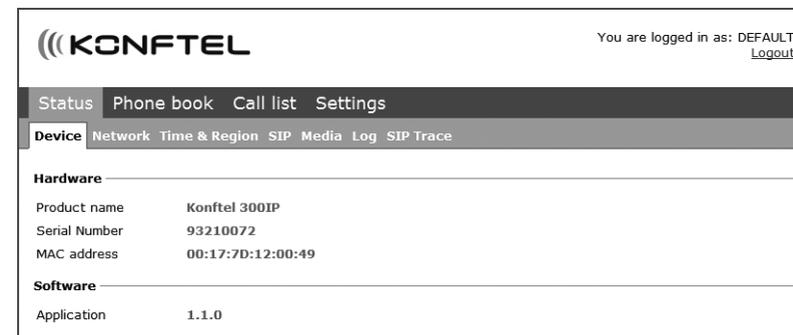
Le numéro de série, l'adresse réseau et la version logicielle du téléphone se trouvent dans l'onglet **Basic**. L'administrateur dispose d'autres onglets pour modifier les paramètres relatifs au réseau, au serveur de temps, aux comptes SIP et aux médias.
