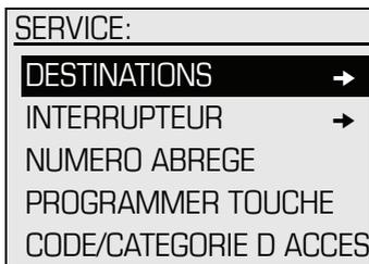
La structure de menu comprend plusieurs niveaux. Dans cette structure, la première ligne affiche le menu actuellement sélectionné et la deuxième ligne une option de ce menu. La présence à côté d'une flèche signifie que l'entrée correspondante comporte d'autres options.
